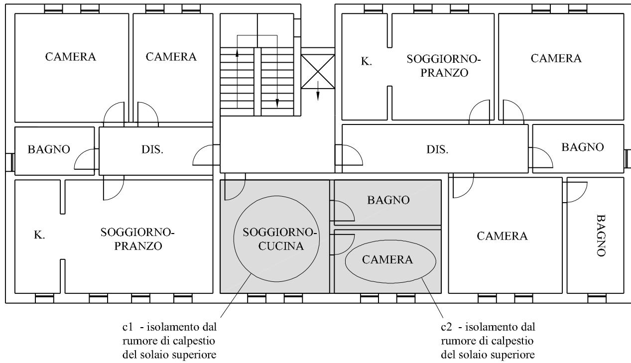
Figura I.4 Pianta dell'edificio con evidenziati gli elementi tecnici per l'isolamento al rumore da calpestio, per l'UI in esame
