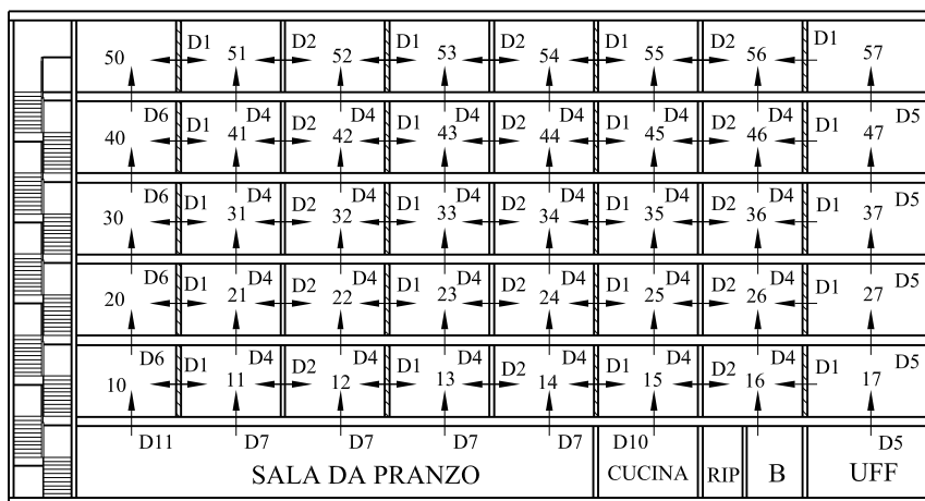
Figura I.7 Sezioni e pianta piano primo dell'albergo con evidenziati gli elementi tecnici pertinenti per l'isolamento acustico normalizzato delle partizioni
